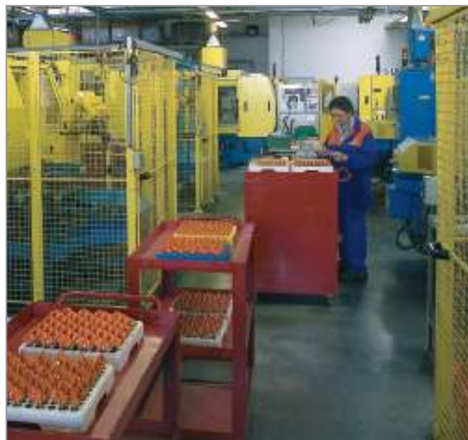
Cargando el control numérico multi-axial automático.
